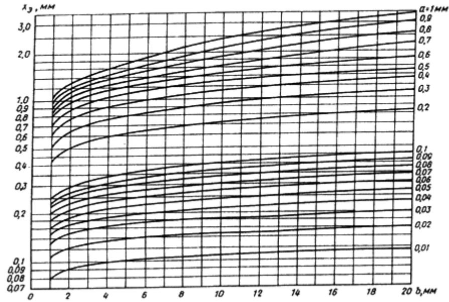
Рисунок Г.1 - Номограмма для определения эквивалентного размера протяженных объектов различия при расстояниях от глаза до объекта, больших 500 мм, эквивалентный размер определяется по номограмме, приведенной на рисунке 2.
